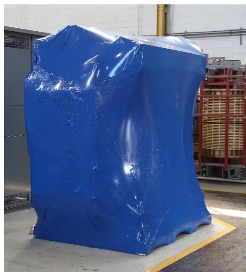
Figure 2: Transformateur noyau-bobines avec emballage thermo rétractable
